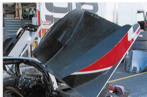
ドアの内側は精緻なダクトを形作る。写真のドア右端がラジエーター直前に来る寸法だ。
