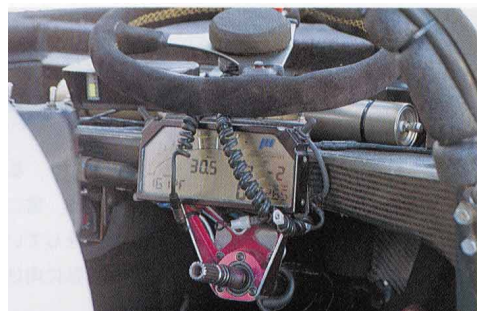
メーターはデジタル表示。中央の数字はブースト計。斜め右下の大きめの数字はシフトポジション。現在はニュートラルを示すゼロ。エンジン回転はバーグラフで示される。
