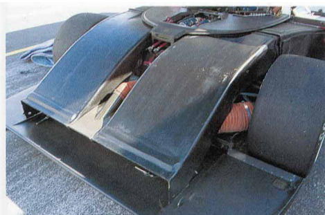
コクピット直後に位置するラジエーターとインタークーラーへのダクト。大きな開口部は効率のよい最先端に置かれる。
